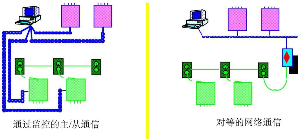
开—关状态以每个装置内微处理器层上的微弱信号而终止。称为**收发器**的一个组件为在网上长距离传送信号的通道而调控微处理器层的开—关信号。装置间的通道具有各种物理特征，称为**传输介质**。而**收发器**则是一个电子模块，在微处理器通信端口和一个物理介质间提供物理接口。该物理介质也称为**信道**，它把数字通信包传送给网络中的另一些装置。信道类型和收发器类型的选择影响传输速度、距离和网络拓扑。
