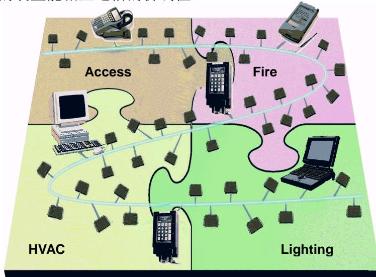
LONWORKS 控制网的复杂程度不一，从机器内装的小网到几千个节点的控制熔化用激光器、造纸机和楼宇自动化的大网。在楼宇控制产业中，充分利用 LONWORKS 技术意味着对所有楼宇系统采用共用的基础结构。这使得设计人员能消除过多的竖向集成，它常常是竖向孤立的原因。上图直观表达了这一目标，说明了一个理想的开放系统的实施。
