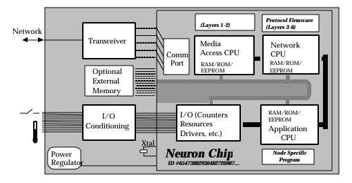
COMPONENTS OF A LONWORKS DEVICE
